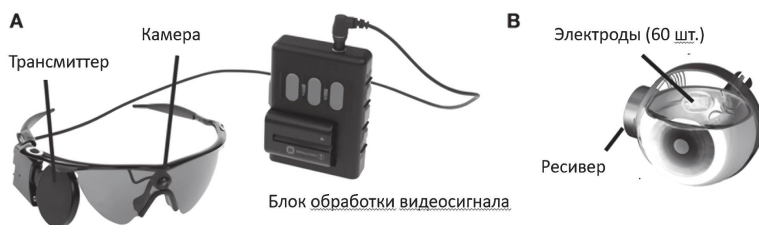
Рисунок 7. Основные компоненты ретиальной протезной системы
