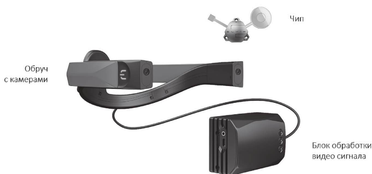
Рисунок 8. Основные компоненты нейроимпланта «ELVIS V»
