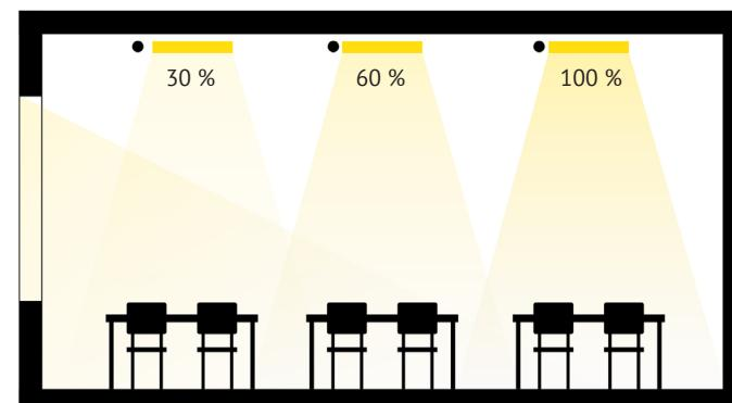
Принцип управления освещением в учебном помещении с помощью датчиков освещенности
