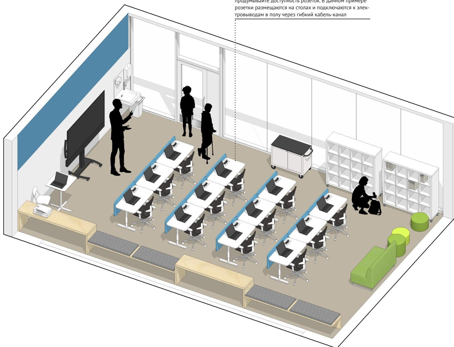
продумывайте доступность розеток. В данном примере розетки размещаются на столах и подключаются к электропроводам в полу через гибкий кабель-канал
